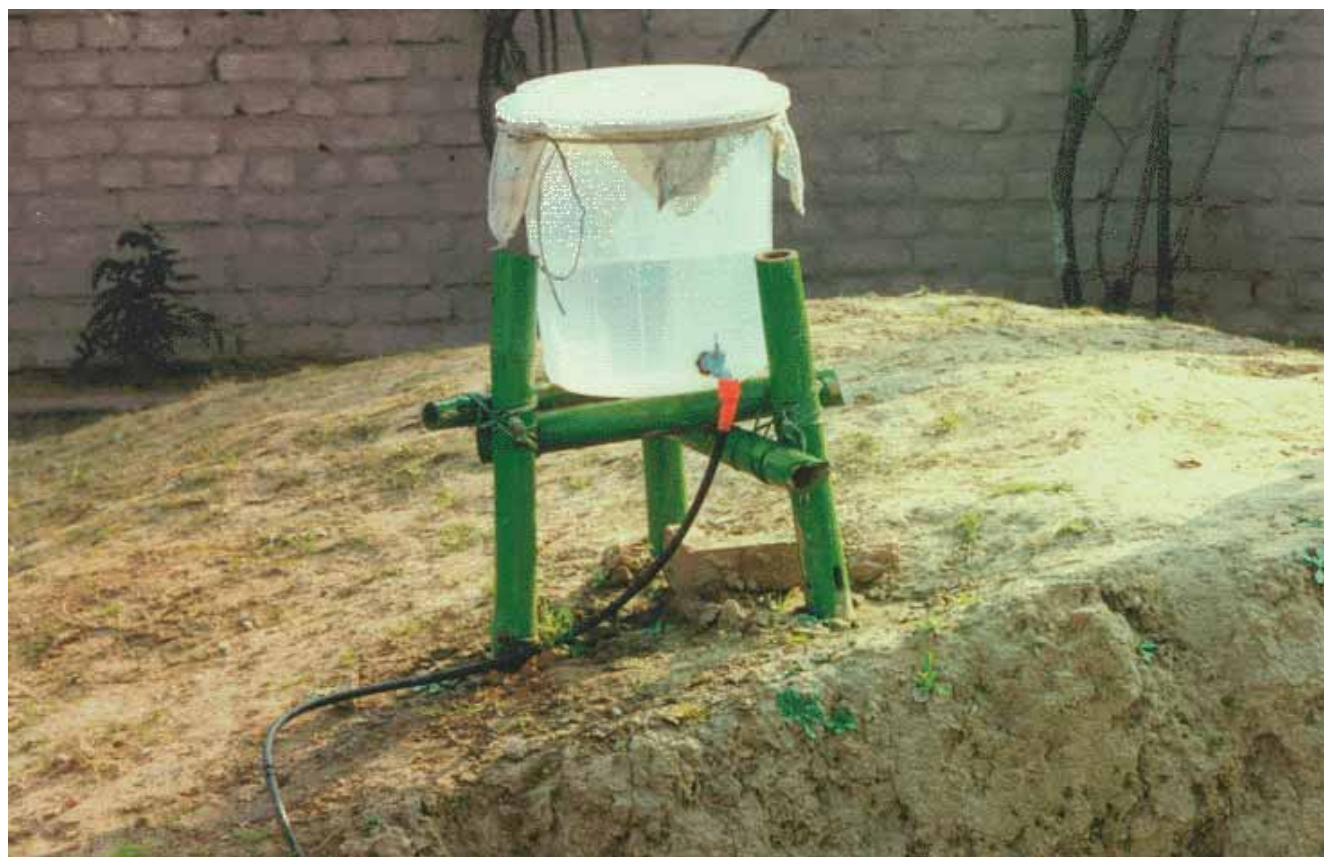
El juego de balde para irrigación por goteo de bajo costo en el laboratorio de pruebas del IDE en India cerca de Nueva Delhi. Un producto simple con una larga fase de pruebas y errores para hacerlo a la medida de las necesidades de los horticultores pobres.
